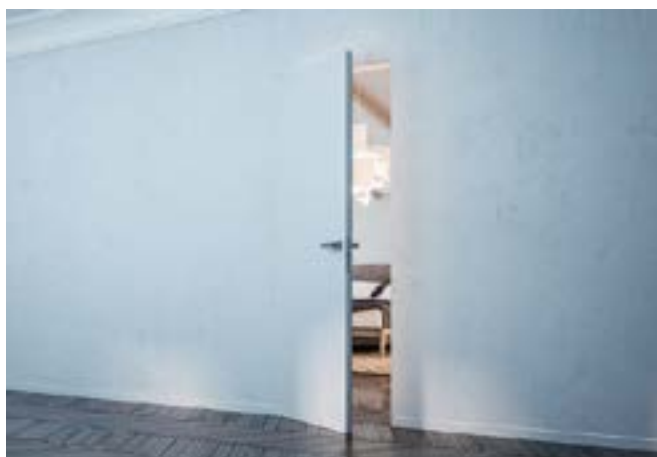
Eclisse Syntesis Line battente è la soluzione per installare una porta a battente filo muro, priva cioè di qualsiasi elemento esterno come stipiti e cornici coprifilo.
